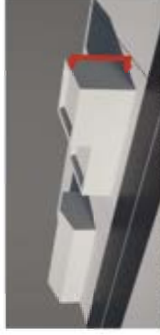
Bâtiment toit plat : la hauteur s'apprécie à l'acrotère
